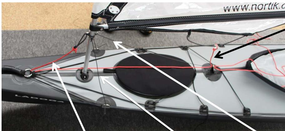
Rote Abspannungsleine, welche am Segel befestigt ist und die bis ins Cockpit läuft. Mit dieser Leine steuern Sie das Segel.
