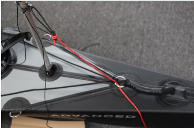
Führen Sie dann die rote Abspannleine, welche an dem flexiblen Gummiband befestigt ist, durch den vorderen D-Ring.
