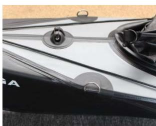
Die beiden seitlichen D-Ringe werden sozusagen über die Kante Ober- und Unterwasserschiff aufgeklebt. Der D-Ring ist dabei so zu positionieren, dass der Ring selbst noch oberhalb des Unterwasserschiffs sitzt, siehe Bilder links.
