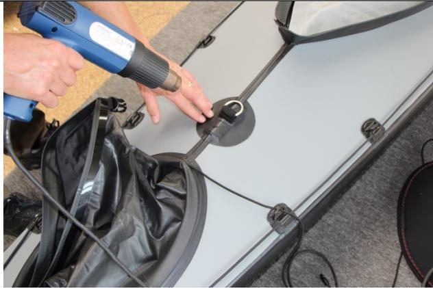
Legen Sie nach der Trocknung den D-Ring auf die ebenfalls mit PVC-Kleber bestrichene Stelle auf dem Boot. Da beides trocken ist, können Sie nun die Position sehr gut ausrichten. Da wird Ihnen nun der zuvor gemachte dünne Bleistiftstrich helfen.
