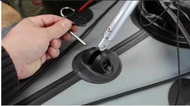
Setzen Sie den Mast in die Multifunktionshalterung und sichern Sie diesen mit dem Splint.
