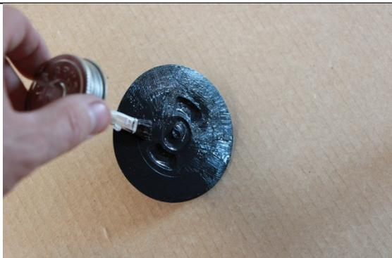
Reinigen Sie die Unterseite des D-Rings / der Multifunktionshalterung mit z.B. Aceton/Reinigungsbenzin und bestreichen Sie diese dann flächendeckend mit PVC-Kleber. Nehmen Sie einen Karton o.ä. als Unterlage.
