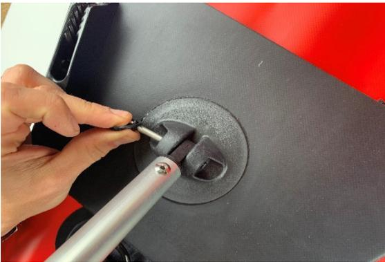
Setzen Sie dann das Segel in die Masthalterung, so dass die auf den Mast aufgenietete **Öse in Richtung Heck** zeigt und sichernie den Mast mit dem Splint.
