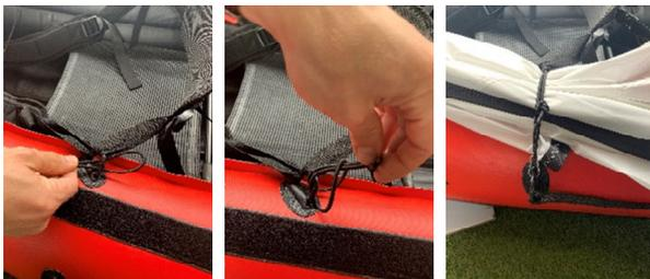
Zum Verstauen des Segels bei Nichtgebrauch fädeln Sie die **elastische Schlinge** durch einen D-Ring der Rückenlehne und befestigen Sie den **zweiten Karabiner**.
