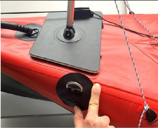
Für den Fall, dass Sie am Wind segeln möchten, können Sie zusätzliche Befestigungspunkte befestigen.
