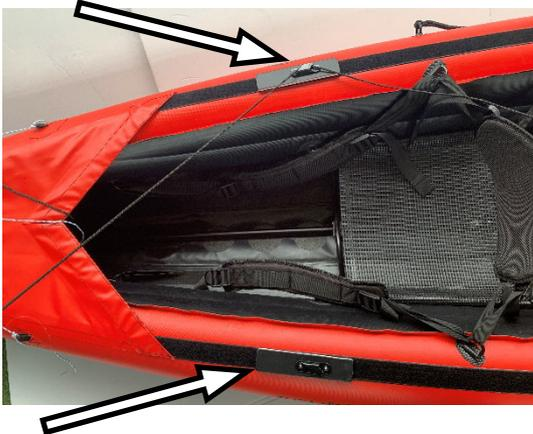
Positionieren Sie die **zwei Vertäuungplatten** an einer für Sie gut erreichbaren Stelle und hängen an einer die Leine ein.
