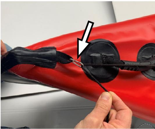
Befestigen Sie einen der beiden Metall-**Karabiner** an der vorderen Schlaufe am Bug.
