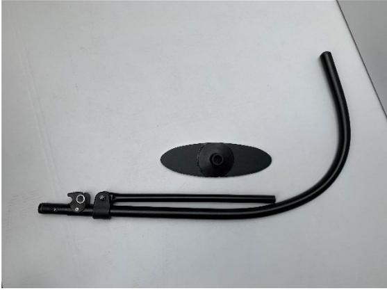
Der Mastfuß-Support dient dazu, den Druck des Segelmasts besser auf den Kiel zu übertragen.
