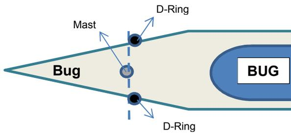
Entweder genau auf der Linie des Masts oder leicht vor dem Mast (ca. 1-2 cm).
