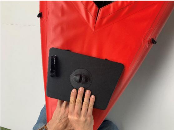
Setzen Sie die **Segelplatte** darauf und nehmen den Sicherungssplint aus der Masthalterung.
